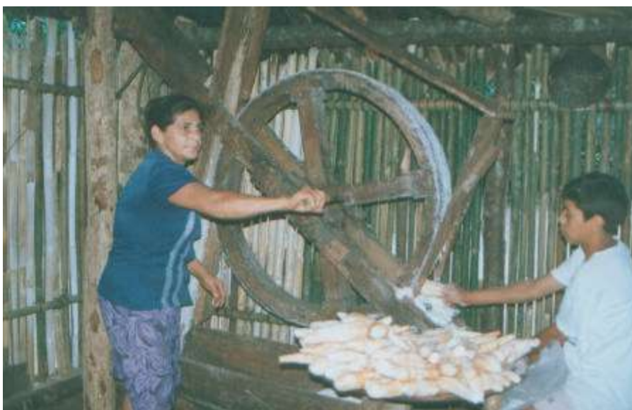
Figura 5.2. Etapa do processo de fabricação de farinha de mandioca utilizando o tradicional “tráfico”.
